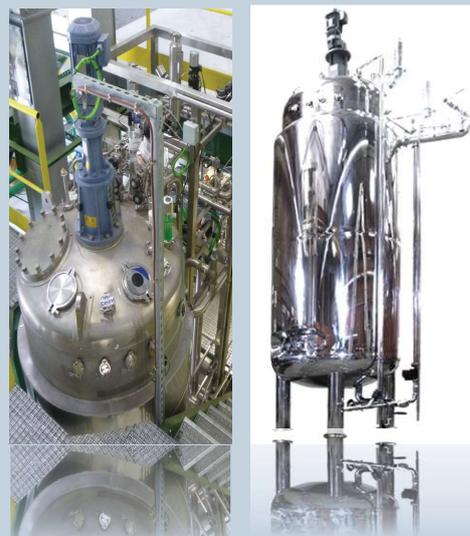
**Biorreactor fabricado totalmente en acero inoxidable de capacidad de trabajo 6000 litros.**
