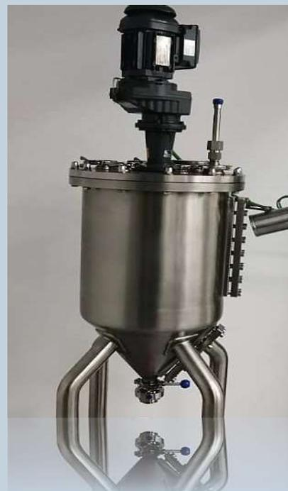
Biorreactor fabricado totalmente en acero inoxidable de capacidad de trabajo 50 litros diseñado para trabajo en sala ATEX.
