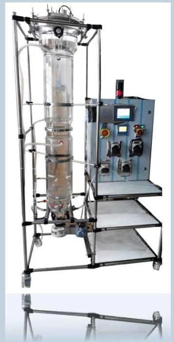
Equipo diseñado a medida e instalado en un laboratorio piloto destinado para la purificación de metabolitos de tamaño variable.
