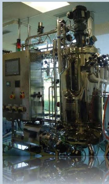
Fermentador fabricado totalmente en acero inoxidable de capacidad de trabajo 120 litros con sistema CIP integrado. Diseñado para cultivos fúngicos con bajo estrés mecánico
