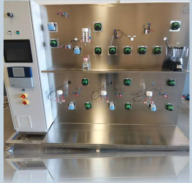
Recreación del sistema digestivo humano, capaz de simular con precisión el comportamiento del sistema digestivo.
