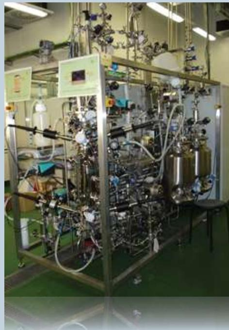
Skid con múltiples reactores de varios volúmenes preparados para investigación de parámetros de proceso. 2 biorreactores encamisados de 20 L y 3 de 7,5 L.
