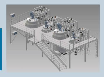
Instalación llave en mano: consiste en un escalado 30L, 300L, 3000L, Sistema Automático CIP/SIP y Sistema pH.
