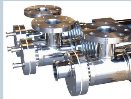
Los intercambiadores tubulares suministrados por Bioprocess Technology están contruidos generalmente con tubos corrugados. En algunos casos especiales, es posible la utilización de tubos lisos. Uno de los factores más importantes en la transmisión de calor es la turbulencia. Mediante la corrugación, conseguimos producir una turbulencia artificial para mejorar esta transmisión de calor. Los principales efectos d la corrugación son:
