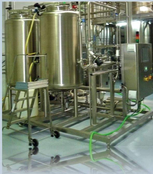
**Sistema Automático para procesos CIP / SIP compuesto por dos depósitos de capacidad aproximada 1000L para preparación y recuperación de soluciones de limpieza.**
