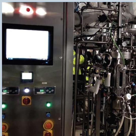
Fermentador de 7 litros anaeróbico, a presión, agitado y encamisado. Permite un control muy preciso de parámetros de crecimiento.
