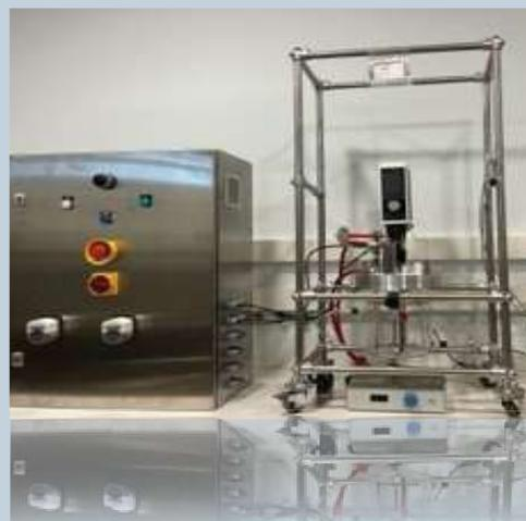
Biorreactor de cristal cilíndrico encamisado con volumen de trabajo de 2L (volumen de total 3L), para acoplar reactor concéntrico cerámico con diámetro de 80mm.
