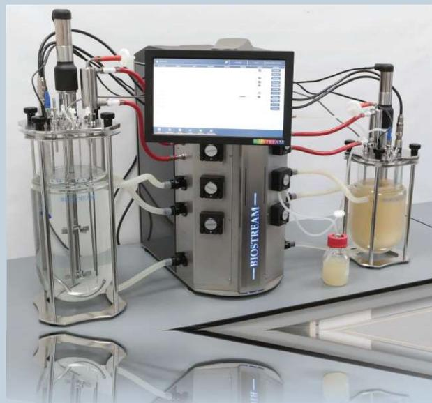
**2 Biorreactores de 5L y 15L totales, fabricados en borosilicato. Con controlador único y software incluido.**
