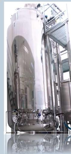
**Biorreactor fabricado totalmente en acero inoxidable de capacidad de trabajo 3000 litros con sistema de esterilización "in situ".**
